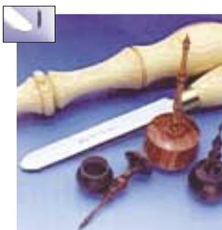
Estos raspadores deslizantes se han incorporado hace poco tiempo a las herramientas de torneado obteniendo una gran popularidad por su facilidad de uso, de afilado y excelentes acabados. Se trata de una herramienta redondeada y plana por arriba y convexa pulida con un bisel muy alargado por abajo. Es este bisel el que nos ayuda a que la herramienta no se nos enganche en los trabajos de suavizado de cualquier superficie incluso en contra de la veta.
