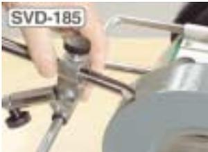
Igual que el anterior, pero con un mejor sistema de sujeción de la herramienta por el interior de la gubia para evitar cualquier movimiento o vibración durante el proceso del afilado. Además permite el afilado de cualquier cuchilla de las que utilizan las herramientas de torno de cuchillas múltiples tipo ROBERT SORBY RS200KT, o RS230. Peso: 360 grs.
