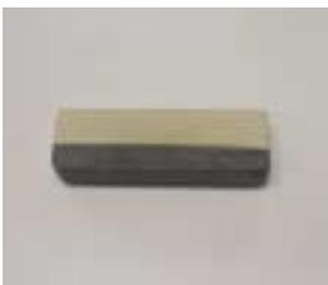
Dimensiones: 75 mm de longitud x 12 mm de ancho x curvatura de diámetros que pueden ir desde 15 hasta 12 mm de diámetro. La cotícula amarilla se presenta siempre sobre una piedra azul de las mismas dimensiones y casi 10 mm de grueso, para asegurar su solidez y garantizar el máximo de uso. Grano 6000-8000. Ideal para gubias de radios grandes e intermedios.
