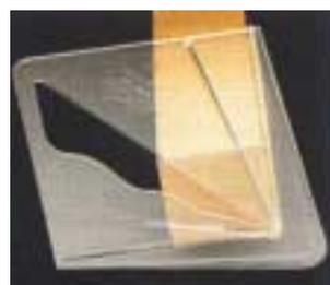
Sencilla pieza plástica con un resalte en escuadra a 90°. Válida para la búsqueda rápida del centro en piezas redondas, cuadradas, hexagonales y octogonales. Se trata de girar la pieza apoyándola en la escuadra de abajo y trazar una línea con ayuda del agujero central. Cuando tengamos dos líneas que se cruzan ya hemos encontrado el centro de una forma rápida. Tamaño: 150 mm x 150 mm aproximadamente, pues no es una pieza cuadrada perfecta.
