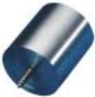
Mandril de sujeción de madera, de 1 1/2"-38,10 mm de diámetro, rosca de 3/4"x16 tpi, y tornillo en la punta. Recomendado para la fijación de piezas de hasta 6"-152 mm de sección, aunque no es habitual usarlo para estos diámetros, sino más bien para copas y vasijas pequeñas.
