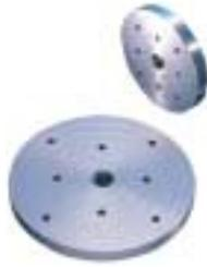
Plato frontal de 6"-152 mm con rosca RECORD 3/4"x16 tpi. Construido en fundición de acero, cuenta con 8 agujeros avellanados para atornillar la pieza. Una regla general nos dice que el diámetro de la madera que sujetamos no debe exceder en 3 veces el del plato que la sujeta. En este caso el plato es de 6"-152 mm y por tanto la madera no debe tener un diámetro mayor a 18"-457 mm.
