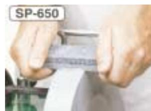
Con el afilado de gubias y herramientas con formas, la piedra de afilado sufre deformaciones que debemos corregir para seguir consiguiendo unos biselados de corte perfectos. Este dispositivo se coloca sobre el soporte universal y de una forma guiada lo
