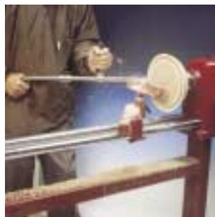
mos cortando piezas de gran dimensión nos interesará poner esta prolongación del brazo principal RS202. Con este apoyo tendremos una mayor palanca de trabajo y un apoyo auxiliar a modo de muleta en la que nuestro brazo descansa y nos da una mayor maniobrabilidad para cualquier movimiento.
