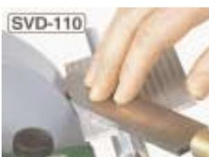
SopORTE plano orientable para el apoyo de cuchillas de ebanista, herramientas de talla y de torno. Por su gran superficie de apoyo
