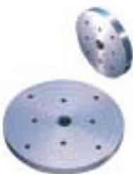
Plato frontal de 4"-102 mm con rosca RECORD 3/4"x16 tpi. Construido en fundición de acero, cuenta con 8 agujeros avellanados para atornillar la pieza. Una regla general nos dice que el diámetro de la madera que sujetamos no debe exceder en 3 veces el del plato que la sujeta. En este caso el plato es de 4"-102 mm y por tanto la madera no debe tener un diámetro mayor a 12"-305 mm.
