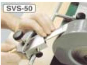
Permite el afilado de gubias de torno o talla desde 25 a 50 mm de ancho. Ideal para las gubias de desbaste y perfilado.
