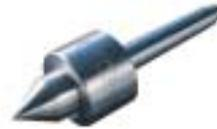
Con punta a 45° para inserción en cono Morse nº 1, este contrapunto giratorio fabricado en acero rico en carbono, tiene en su interior 2 rodillos de bolas que hace que la madera gire al presionarse y evitemos así el quemado de la pieza por la excesiva fricción.
