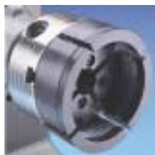
Con estas garras podemos sujetar piezas de hasta 29"-737 mm de diámetro y 19"-483 mm de longitud. El estriado interior favorece una firme sujeción. Se consiguen así las máximas capacidades de sujeción con la mordaza SUPERNOVA.
