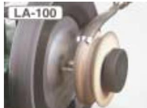
Disco de cuero perfilado en U y en V para el asentado de filo y pulido del interior y exterior de las gubias. Se utiliza conjuntamente con la pasta de pulido. Este disco se monta con una prolongación de eje que nos permite roscarlo como continuación de la máquina hacia el lado del disco de asentado del filo.
